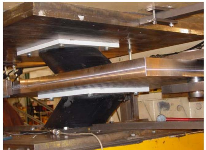
Ensaio dum Par de Aparelhos de Apoio HDRB
